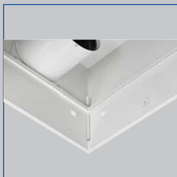
Innvendig målerør for innsamling av partikler til måling
